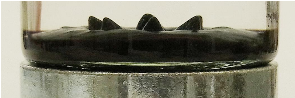
Abbildung 30: Ferrofluid unter Einfluss eines Elektromagneten mit Wertepaar 2.
