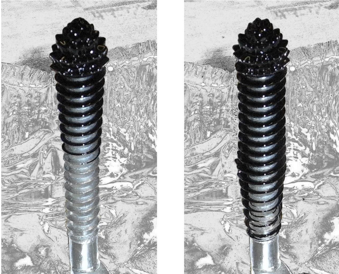
Abbildung 23: Ferrofluid wandert der Schraube entlang nach unten.
