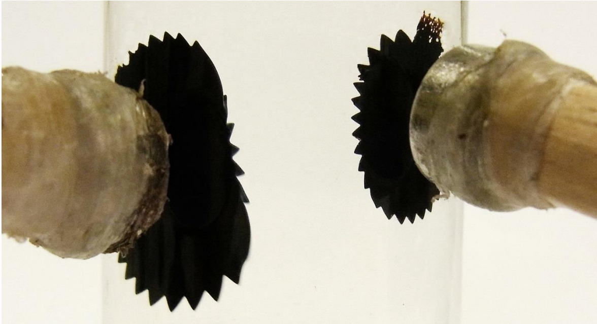
Abbildung 19: Ferrofluid unter Einfluss von zwei Magneten gleicher Polung.
