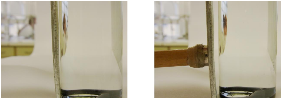
Abbildung 27: Magnetfeld durchdringt Stahl nicht. Rosensweig-Instabilität bleibt aus.
