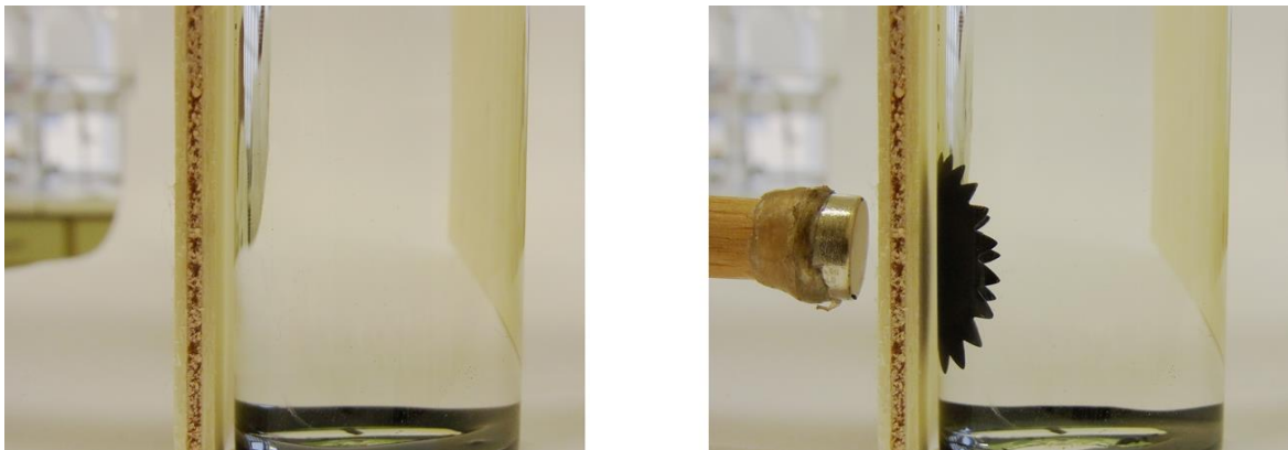
Abbildung 25: Magnetfeld durchdringt Holz und erzeugt Rosensweig-Instabilität.
