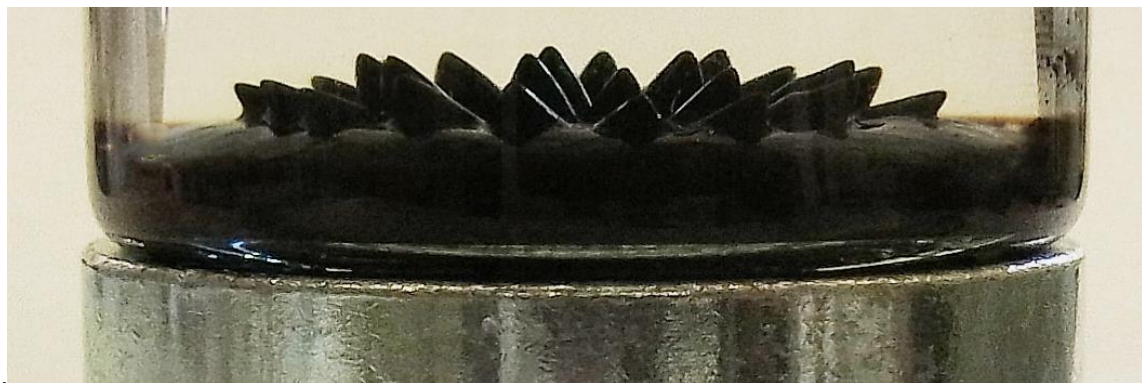
Abbildung 32: Ferrofluid unter Einfluss eines Elektromagneten mit Wertepaar 4.
