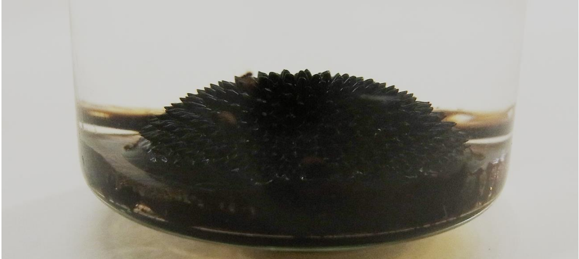
Abbildung 21: Durch den Magneten entsteht eine Rosensweig-Instabilität.
