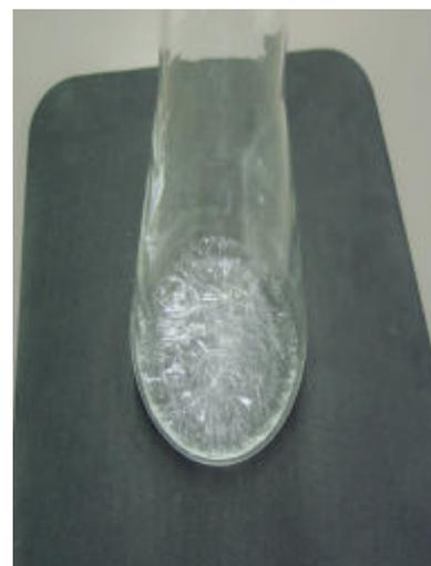
**Bild 4: auskristallisiertes Glaubersalz**
