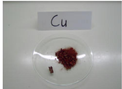
**Bild 12: abfiltriertes Kupfer**
