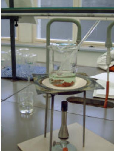
**Bild 11: Kupfer, gefällt mit Eisenpulver aus einer Kupfer(II)-Salzlösung**
