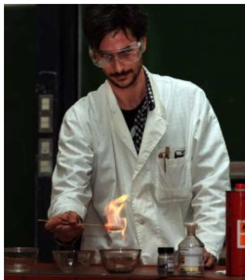
Abb. 19. Ozon entzündet mit Ethanol getränkte Watte
