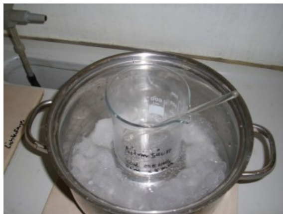
Abb. 5. Fertige Nitriersäure im Eiswasserbad
