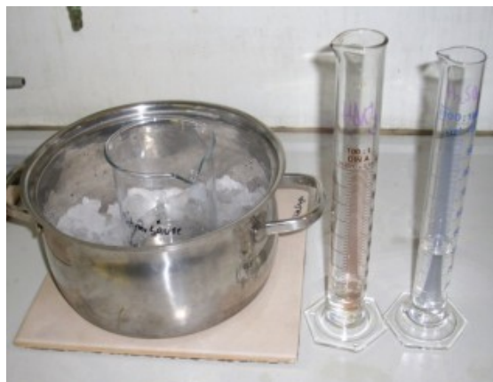
Abb. 4. Herstellung der Nitriersäure
