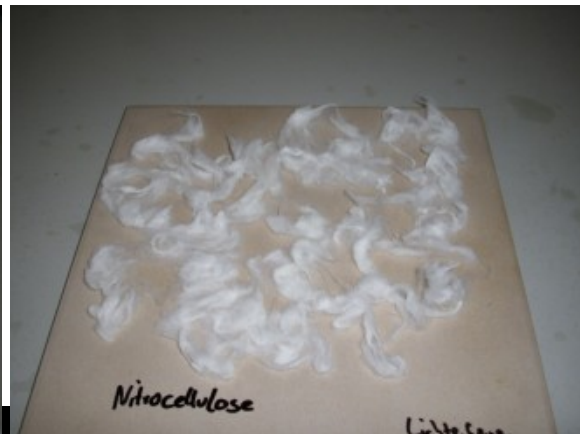
Abb. 11. Trocknen auf angewärmter Keramikplatte
