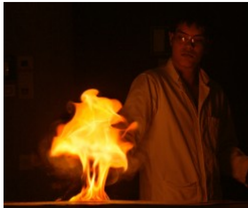
Abb. 21. Schießbaumwolle verpufft rückstandsfrei
